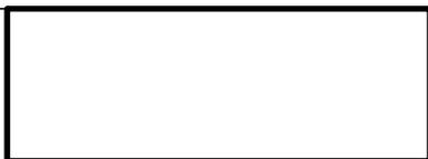
Esta figura será usada para representar o processamento, ou seja, realização de cálculos. Será dentro dessa figura que ficarão contidas informações como “ $X = 2 + 27$ ”, sendo X uma variável qualquer, que adquire nomes e funções conforme a vontade do programador.
